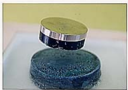
図2 Y211 の微細化によってピン止め効果を引き出したバルク Y-Ba-Cu-O 体による浮上実験。
